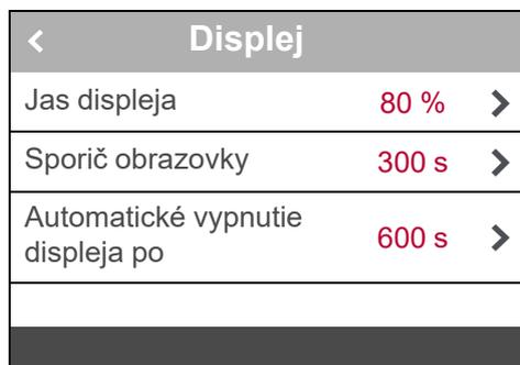
V menu „Displej“ môžete nastaviť jas, sporič obrazovky (zobrazí teplotu), príp. automatické vypnutie displeja.
