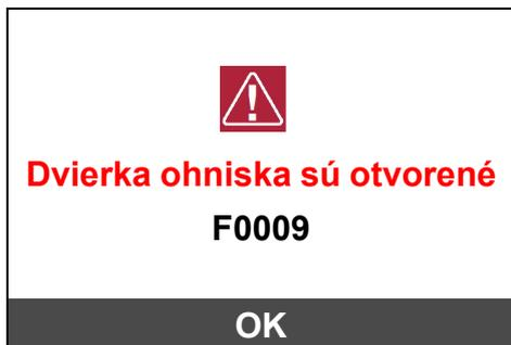
Kachle už nie je možné automaticky sprevádzkovať. Obsluha si môže na displeji prečítať chybového hlásenie. Po odbornom odstránení poruchy a potvrdení chybového hlásenia na ovládacej jednotke je možné kachle opäť uviesť do prevádzky.
